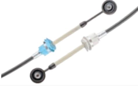
**10509869****Vites Teli / Gearshift Cable / Трос Коробки Передач**
