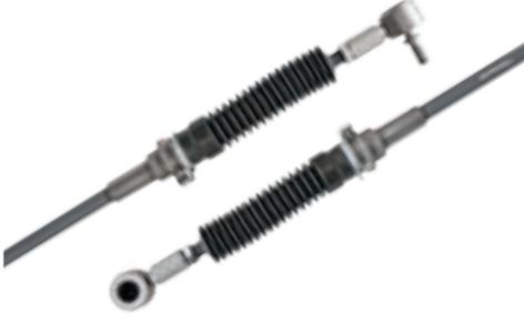
**10509076****Vites Teli / Gearshift Cable / Трос Коробки Передач**
