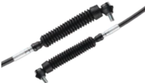
**10509047 B****Vites Teli / Gearshift Cable / Трос Коробки Передач**
