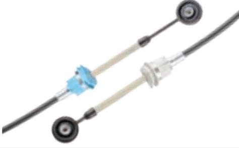
**10509893****Vites Teli / Gearshift Cable / Трос Коробки Передач**
