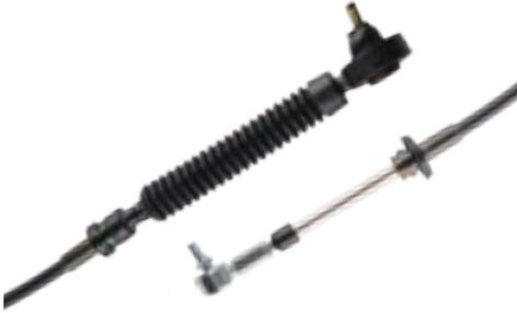
**10509057****Vites Teli / Gearshift Cable / Трос Коробки Передач**
