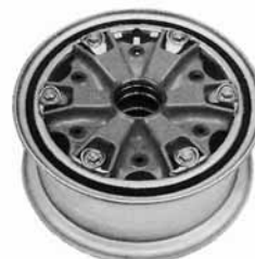
Ступица колеса со спицами с колёсным ободом UNILEX, 20"
